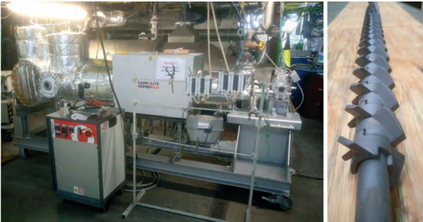
Abb. 2: Aufbau der Technikumsversuchsanlage und SiC-Reaktorschneckenwelle
