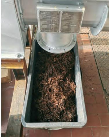
*Abb. 3: Austrag des Schneckenrockners mit getrocknetem, gebeiztem Stroh*
